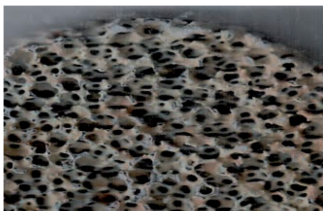
Fot. 1. Fragment powierzchni katalizatora o nośniku z SiC otrzymanego z firmy JMJ Puchalski i Krawczyk
