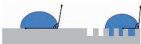
Rys. 8. Kąt zwilżania na płaskiej powierzchni i powierzchni z dużymi porami
