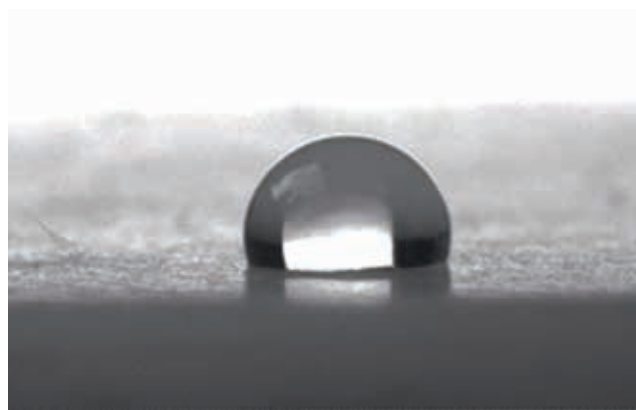
Fot. 2. Kształt kropli na powierzchni hydrofobowej (płytką teflonową, kąt zwilżania między 90^\circ a 120^\circ )
