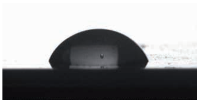
Fot. 3. Kształt kropli na powierzchni hydrofilowej (legitymacja studencka, kąt zwilżania pomiędzy 90^\circ a 50^\circ )
