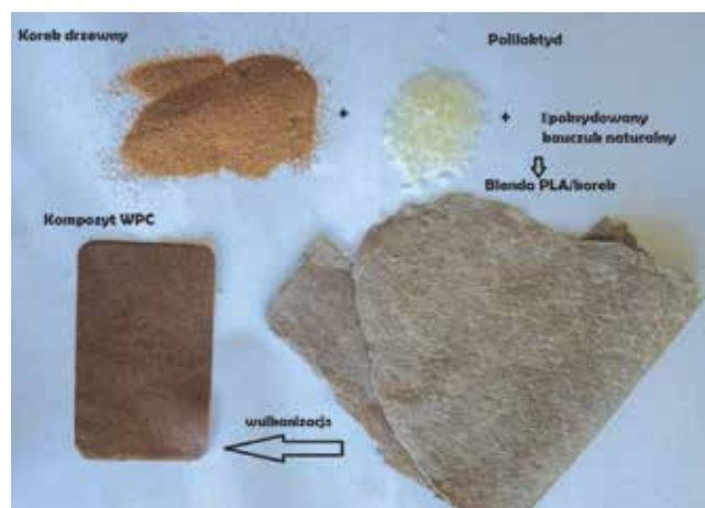
Fot. 3. Napełniacz z korka, kompozyty PLA z korkiem (fot. A. Wieczorek)
