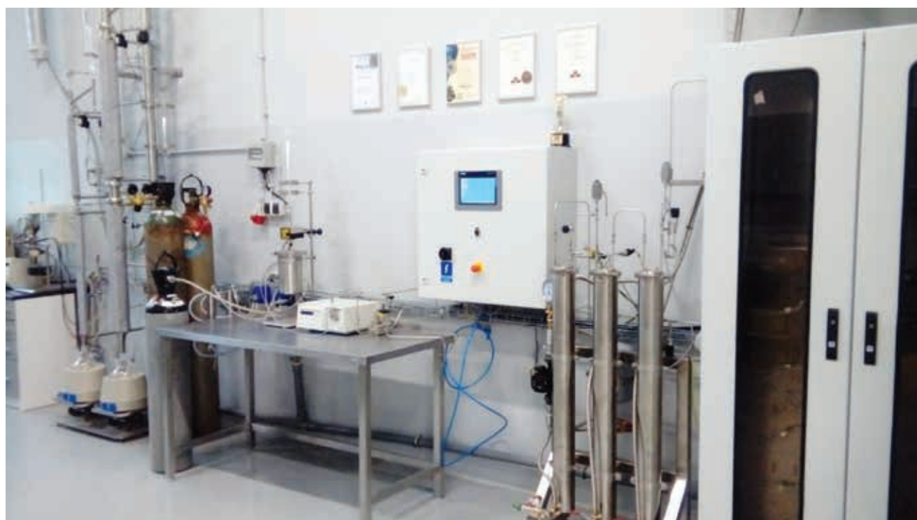
Aparatura do katalitycznego sprzęgania bioetanolu, znajdująca się w IChOiE Pł (fot. Izabela Witońska)
