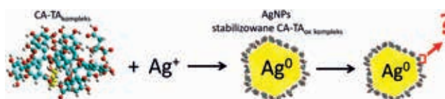
Rys. 1. Schemat otrzymywania nanocząstek srebra modyfikowanych kompleksem cytrynianu sodu z kwasem taninowym
