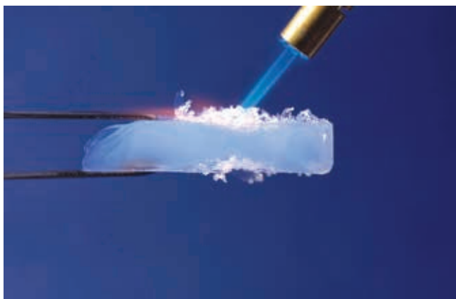
Rys. 1. Aerożel w płomieniu palnika [5]
