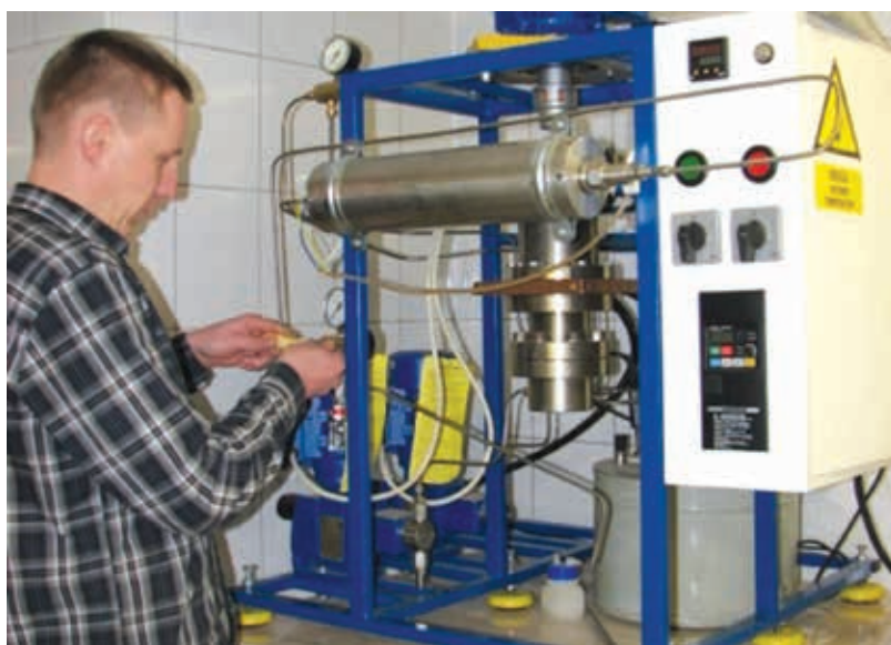
Reaktor do transestryfikacji oleju roślinnego zbudowany w Zespole Technologii Chemicznej, na którym pracuje dr inż. Radosław Ciesielski
